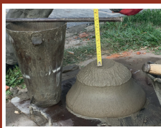
Figura 7: Realización de ensayo de aceptación: consistencia para HRDC muy plástico o fluido ( A \leq 20 cm).
