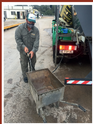
Figura 1: Humedecer y escurrir el recipiente y la pala antes del muestreo.
