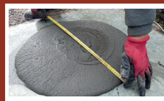
Figura 8: Realización de ensayo de aceptación: consistencia para HRDC muy fluido ( A > 20 cm).
