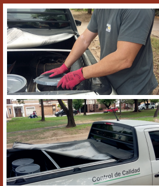
Figuras 4a y 4b: Muestra en un recipiente acondicionado para transportar al laboratorio (moldeo remoto).
