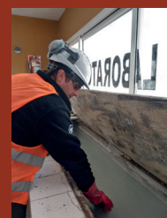
< Foto 4: Desmolde y curado normalizado de probetas.
