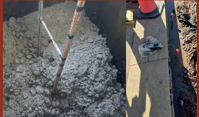
^ Criterio de madurez Paso 2: posicionamiento de sensores y registro de los datos con datalogger.
