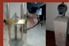
^ F.6: Mediciones de contracción por secado libre.
