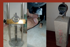
^ F.6: Mediciones de contracción por secado libre.
