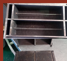
^ F.8: Moldes específicos para contracción restringida.
