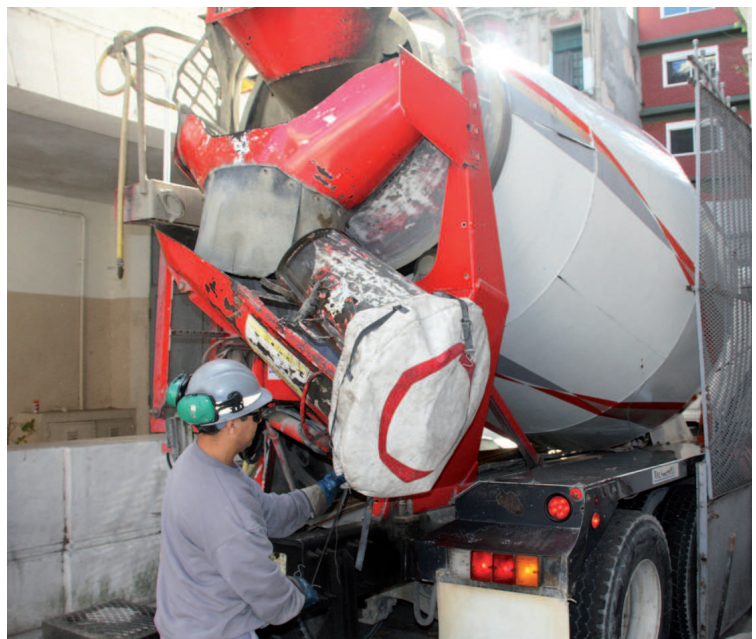
▲ F. 16 Mixer con covertor de canaleta
