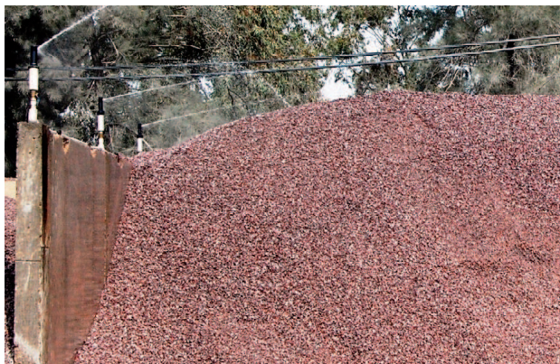
▲ F. 2: Riego por aspersión en la zona de acopio
