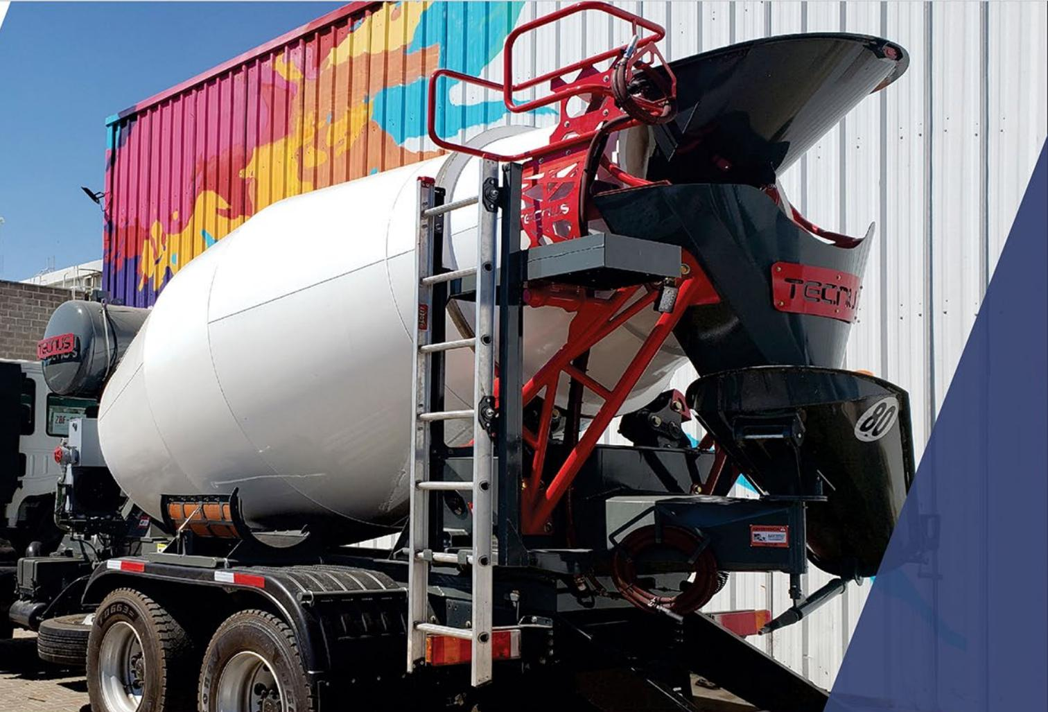
bases construidos con chapa 4.75mm en 450hb de dureza,
