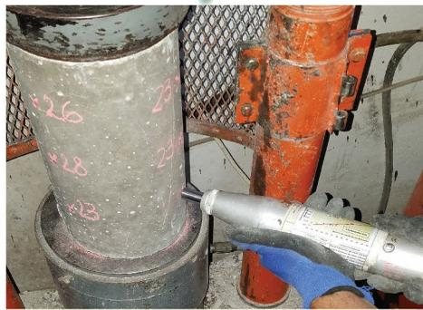
Calibración mediante 9 puntos en probetas 15x30.
