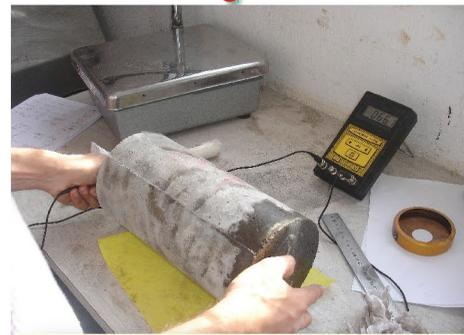
Calibración con probetas de 15x30 que luego son encabezadas y ensayadas a compresión.
