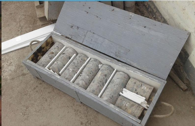
Elementos de laboratorio para realizar ensayos de control del hormigón elaborado.
