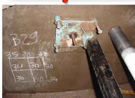
Correlación de ensayos de esclerometría y extracción de testigos.
