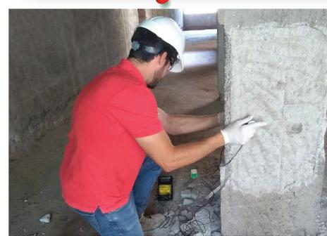
Ultrasonido en columna para estimar resistencias mediante una calibración previa con testigos.
