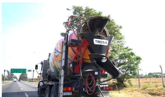
Equipos de Tecnus intervenidos artísticamente. Durante un año se realizaron pruebas en el modelo MN9 de la empresa Pablo Federico: se analizaron datos de dosificaciones, tiempos, viajes y otras variables para poder desarrollar el método de medición automático de asentamiento en motohormigoneras.
