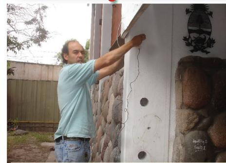
Ensayos de ultrasonido para correlacionar valores con testigos ya extraídos.
