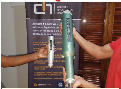
Esclerómetro grande (Tipo III) y convencional (Tipo I).
