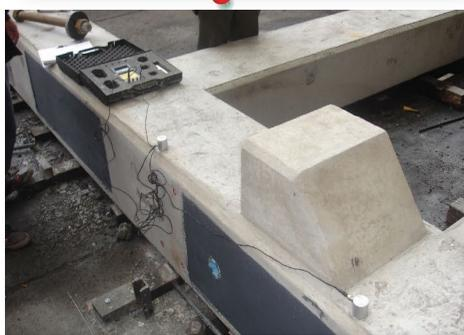
Ejemplo de transmisión superficial de ensayo de ultrasonido.
