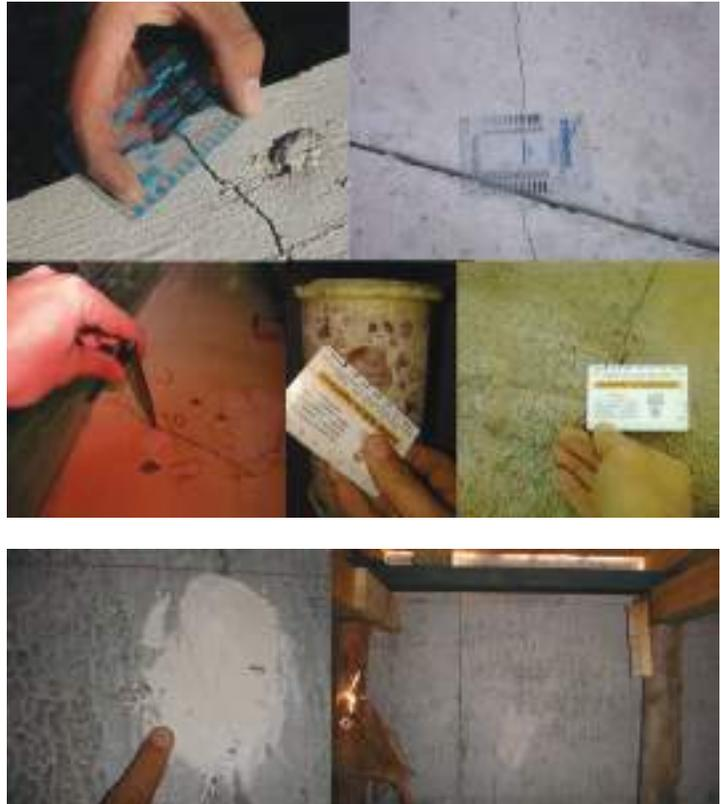
⤴ F2: Medición de ancho de fisuras para relevamiento general
