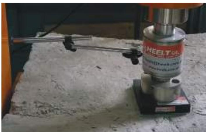
Detalle de aplicación de la carga sobre una placa
